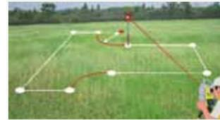
利用参考线进行点的放样和检核。根据已定义的参考线计算目标点的正交放样元素，参考线可以按需要进行平移及旋转。
