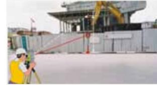
悬高测量主要用于测定建筑物的净高以及电力线高度等，可以通过先测量放置于目标点正下方的基点再瞄准目标点的方法计算得到。
