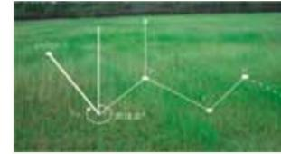
多测回测角为用户提供了测回和方向设置，更有力的支持用户的不同测量工作需要。同时配合平差计算程序，可完成导线的相关计算和平差。
