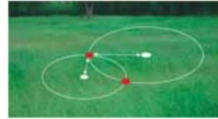
利用COGO程序可以实现多种几何计算功能，包括：正算、反算、角-角交会、角-距离交会、距离-距离交会、线-线交点、垂足计算、延长线计算等。计算出来的点坐标可以存储并用于放样。
