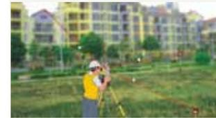
自由设站可计算出测站三维坐标及水平度盘零方向，可以使用多达5个已知点作为后视点参与计算，同时支持盘左盘右双面观测，更大地提高了准确性。
