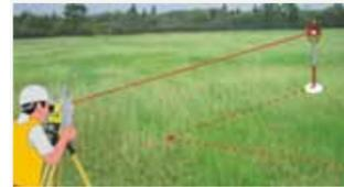
放样点的数据可以来自人工现场输入，也可以来自仪器内存，数据可以通过文件上传并保存在仪器内存。三维放样的放样元素由测站数据和待放样点坐标计算得到。
